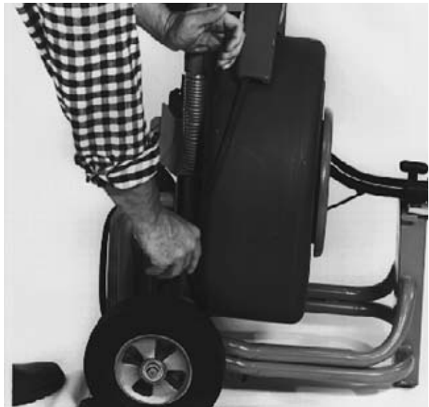
Figura 18 – Afloje la tensión de la correa
