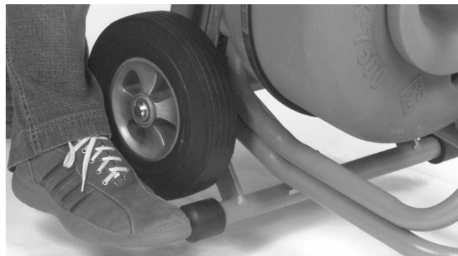
Figure 8 – Engagement de la béquille
