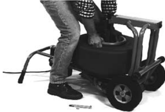
Figure 20 – Positionnement du tambour sur le cadre
