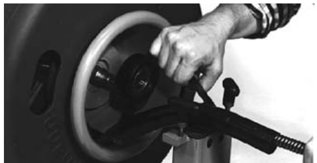
Figura 22 – Extracción del tubo guía
