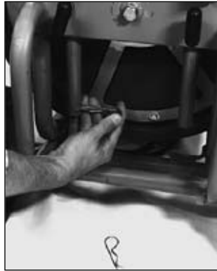
Figura 5 – Asegure el mango con las chavetas de sujeción. Apriete las dos (2) perillas en forma de T
