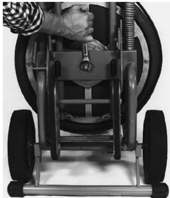
Figura 19 – Extracción del perno en el soporte trasero
