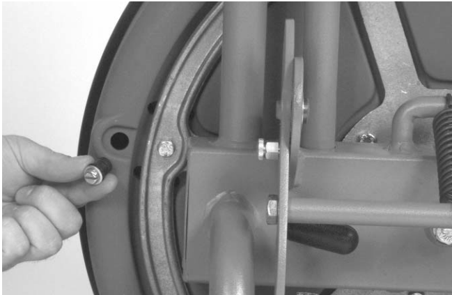
Figure 13 – Orifice de vidange du tambour
