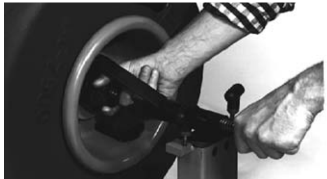
Figure 21 – Retrait de la manette de l'arbre central
