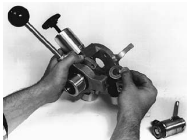
Figura 17 – Introduzca dos arandelas espaciadoras cuando emplee cable de \frac{5}{8} pulg.
