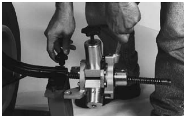
Figura 14 – Extracción del AUTOFEED
