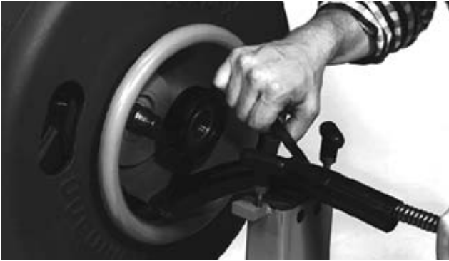
Figure 22 – Retrait du guide-câble
