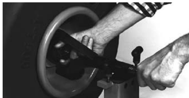
Figura 21 – Extracción de la perilla del eje central
